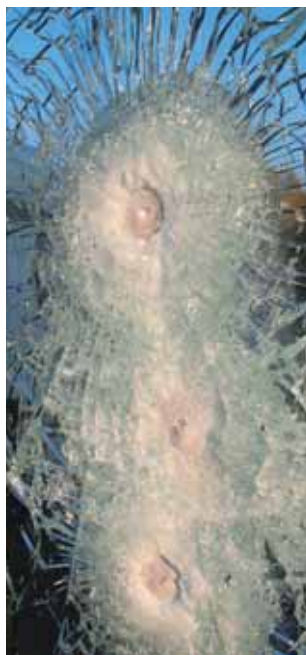
Bild 41. Glas testat för beskjutning för BR 6 NS.
